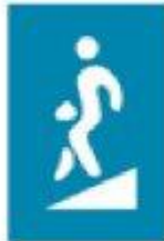
(Π - 63) Ανισόπεδη διάβαση πεζών χωρίς σκαλοπάτια.
