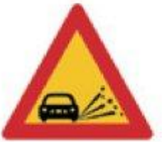
(Κ - 13) Επικίνδυνη εκτίναξη χαλίκων, (ασύνδετο αμμοχάλικο).
